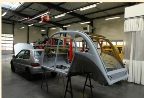
2 CV en cours de reconstruction
