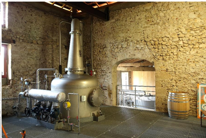
2016 Les alambics 'Belle' en cuivre et 'Nautilus' en acier inoxydable sont allumés
